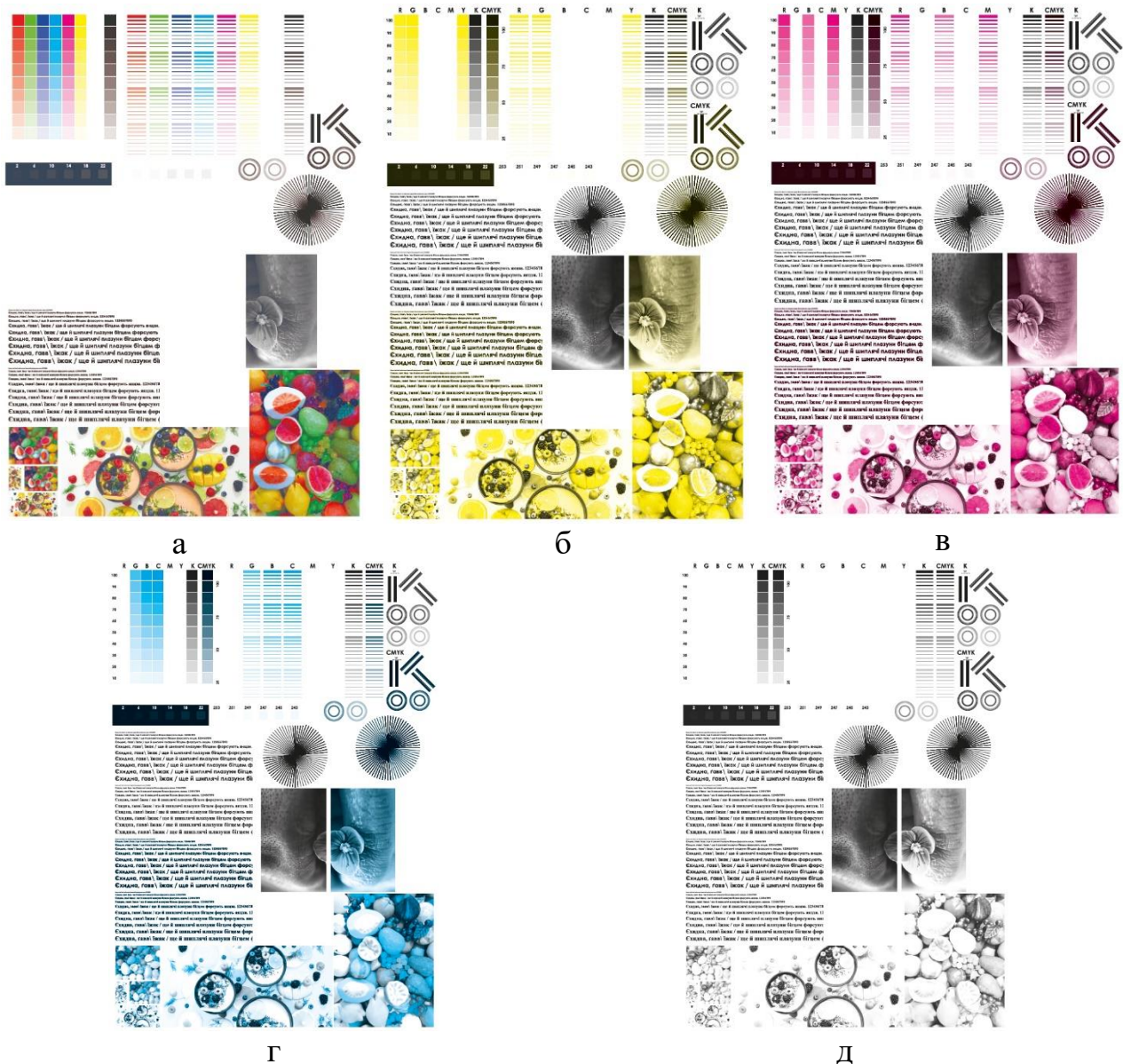
Рис. 1. Тестові форми: а) тест-форма в 4 фарби; б) тест-форма фарб Y+K; в) тест-форма фарб M+K; г) тест-форма фарб C+K; д) тест-форма фарби K.
